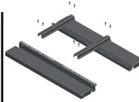
1.) Platzieren Sie die beiden Teile des Kurbelgehäuses und sichern Sie die Wärmepumpenhalter mit mitgelieferten Schrauben, Muttern und M8-Unterlegscheiben.
