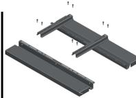
1.) Posizionare le due parti del basamento e fissare i supporti della pompa di calore con viti, dadi e rondelle M8 forniti.
