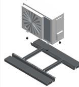
2.) Fissare la pompa di calore ai supporti tramite i giunti antivibranti, con relativi dadi e rondelle.
