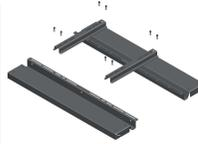
1.) Posizionare le due parti del basamento e fissare i supporti della pompa di calore con viti, dadi e rondelle M8 forniti.
