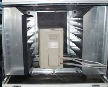
Querträger zur Aufnahme des Klima-, Kälte- oder Wärmepumpengerätes
