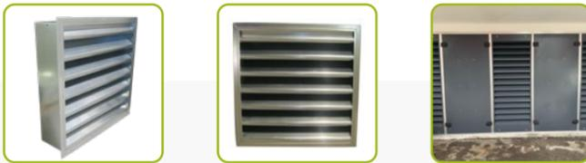
Die Solflex Schallschutzjalousie wird standardmäßig aus verzinktem oder pulverbeschichtetem Blech in RAL Farbtönen hergestellt. Die Jalousietiefe kann je nach der benötigten Dämmung aus **4 lieferbaren Abmessungen** (200, 300, 400 und 600mm Tiefe) gewählt werden. Die Breite ist beliebig möglich je 100mm ab 300 bis 2.500mm. Die Höhe ist beliebig möglich je 150mm ab 450 bis 2.250mm.
