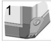
Variante 1: Hijsoog op de onderste hoekverbinding
